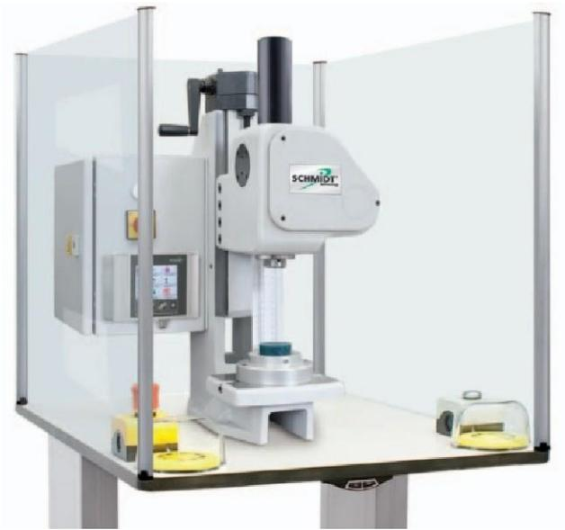
SCHMIDT PressControl 75를 사용하면 빠른 설정 또는 신속한 전환이 가능하며 프레스 파라미터를 쉽게 프로그래밍 할 수 있습니다. SCHMIDT Technology의 입증되고 인증된 안전 기술을 사용하여 수동 작업 셀에 최대 24개의 datasets를 저장합니다. 이 조합은 수동 워크스테이션과 자동화 솔루션 모두에서 사용할 수 있습니다.
